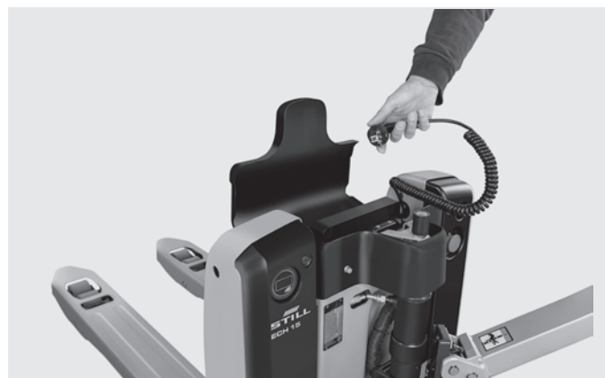
Всегда в боевой готовности: встроенное зарядное устройство с технологией Li-Ion обеспечивает удобство промежуточной подзарядки
